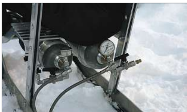
OMBYGGET: Rakettparkens trykkmåler og gassnipler er modifisert fra opprinnelig amerikansk etter europeisk standard.
